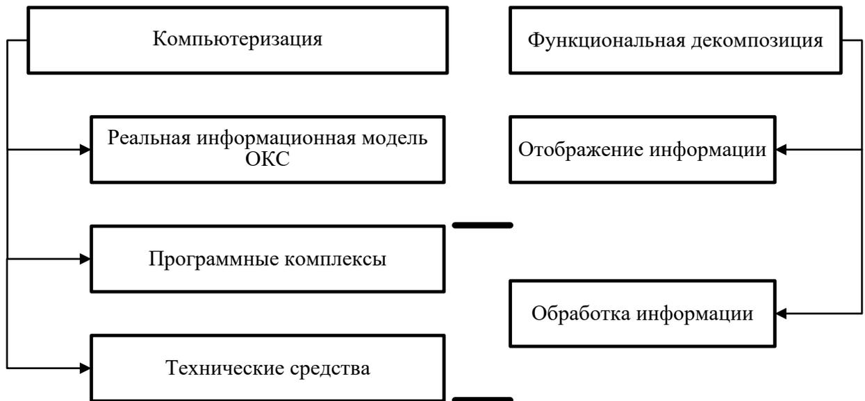
**Рисунок 2.6** – Функциональная декомпозиция и структура компьютеризации строительно-технической экспертизы
