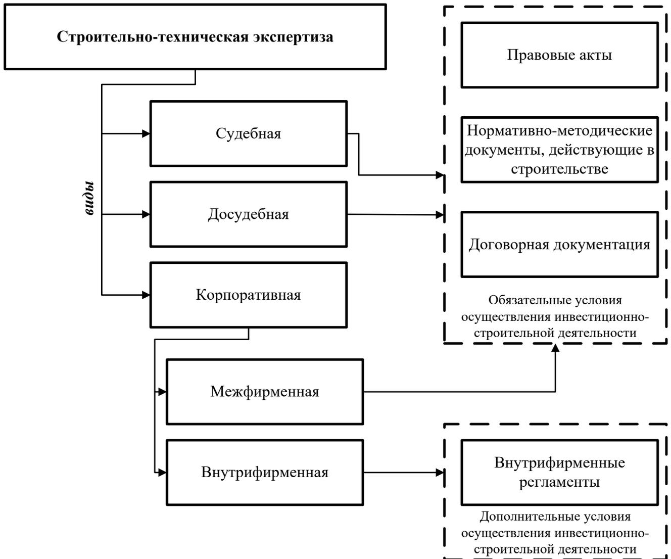
Рисунок 1.1 – Классификация строительно-технических экспертиз
