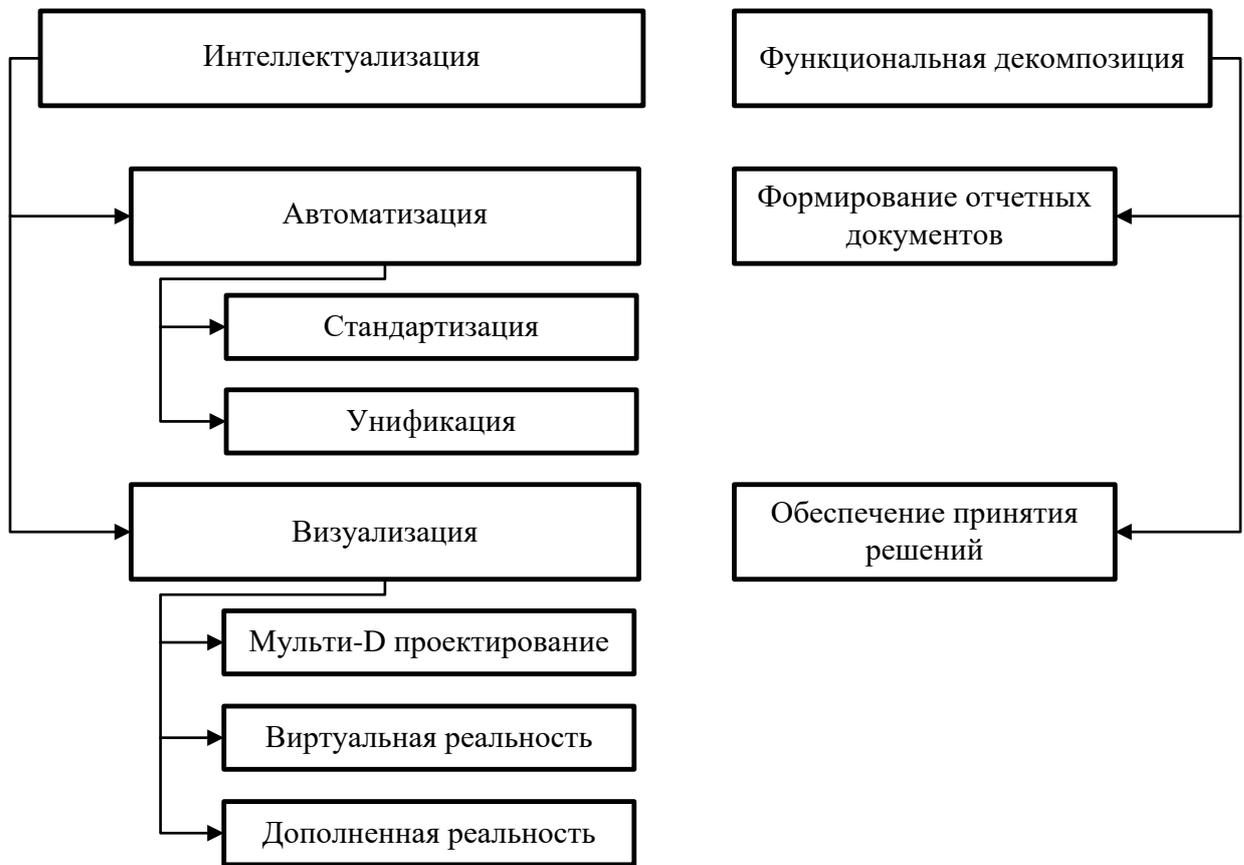
**Рисунок 2.7** – Функциональная декомпозиция и структура интеллектуализации строительно-технической экспертизы
