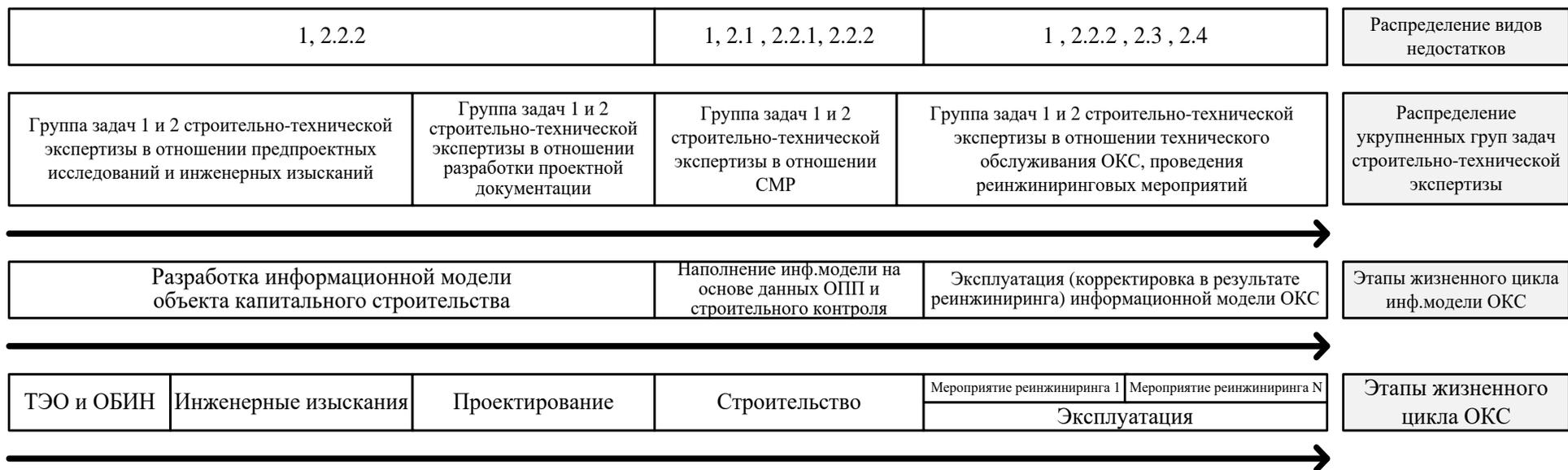
**Рисунок 2.3** – Распределение укрупненных групп задач строительной-технической экспертизы по этапам жизненных циклов здания и его информационной модели. Укрупненные группы задач (в соответствии с п. 1.3):
