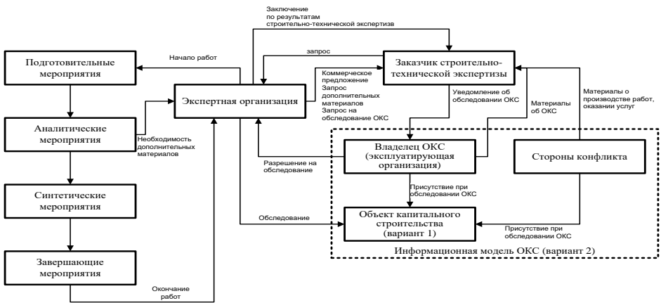
Рисунок 10 – Общая организационная схема строительно-технической экспертизы: вариант 1 – существующая конфигурация взаимодействий; вариант 2 – конфигурация ИМ ОКС
