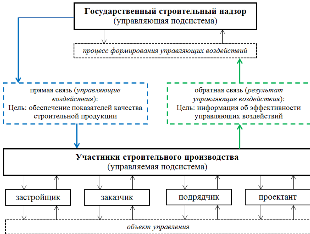
Рис. 7. Схема иерархического взаимодействия между основными участниками строительного производства для обеспечения качества строительной продукции
