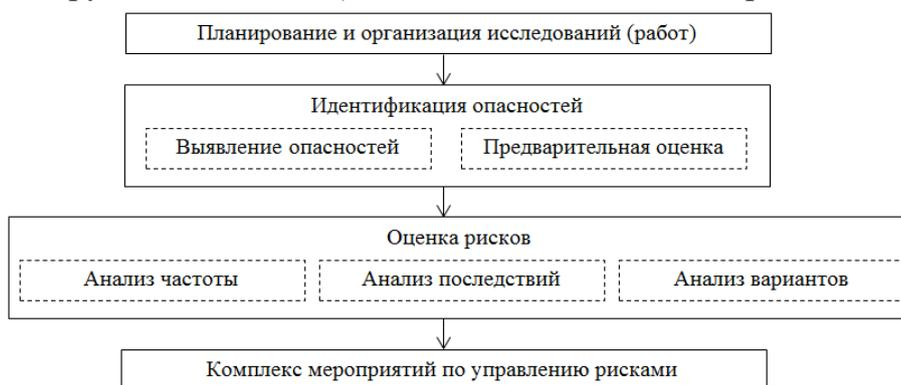
Рис. 2. Структурная схема применения риск-ориентированного подхода при анализе рисков организационно-технологической надежности строительного производства
