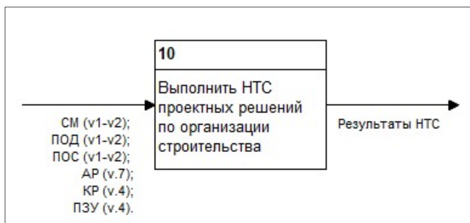
Рисунок №12. Фрагмент диаграммы основных процессов DFD-модели научно-технического сопровождения проектных решений по организации строительства уникальных объектов (макроуровень).
