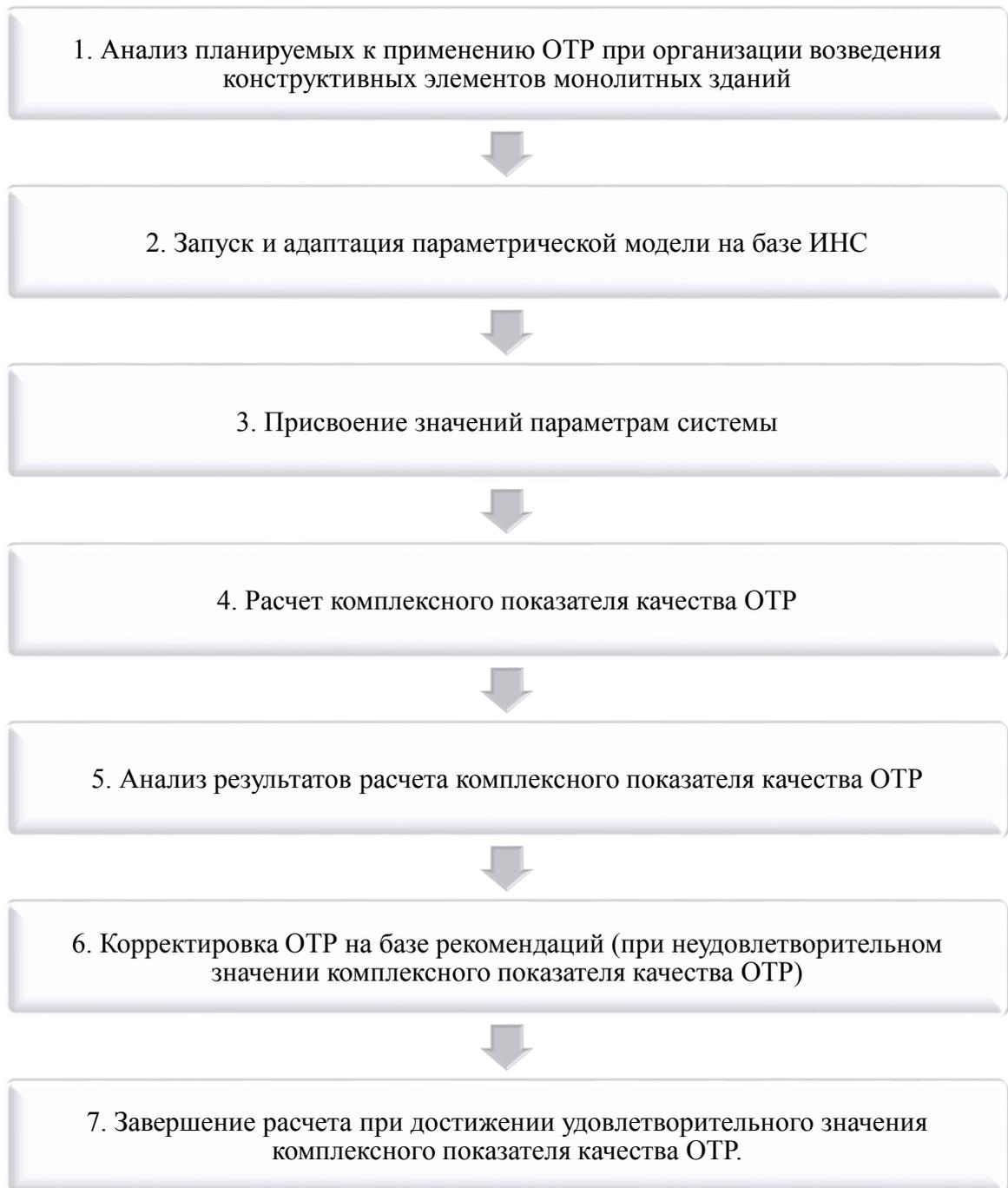
Рисунок 3.12 – Этапы реализации методики оптимизации организации возведения конструктивных элементов монолитных зданий
