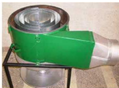
Рисунок 1.11 – Принципиальная схема внутренней конструкции многоканального циклона
