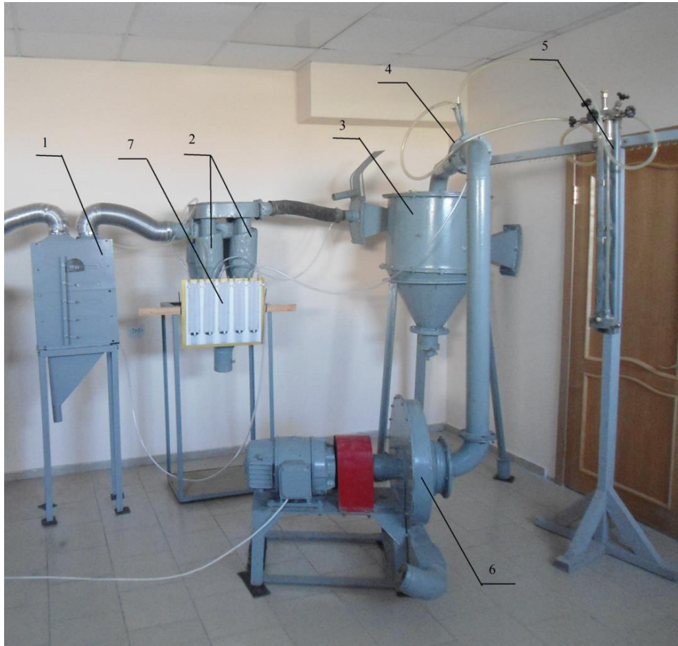
Рисунок 3.2 – Фотография установки пылеосадителя инерционного типа: 1 –пылеосадитель инерционного типа; 2 – осадительные циклоны; 3 – зернистый фильтр; 4 – расходомерное устройство; 5 – жидкостный дифференциальный манометр; 6 – сепарационный вентилятор; 7 – установка жидкостных дифференциальных манометров
