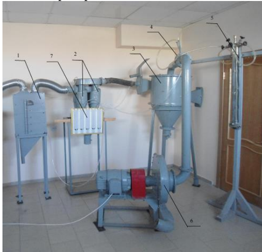
Рисунок 8 – Фотография установки пылеосадителя инерционного типа: 1 – пылеосадитель инерционного типа; 2 – осадительные циклоны; 3 – зернистый фильтр; 4 – расходомерное устройство; 5 – жидкостный дифференциальный манометр; 6 – сепарационный вентилятор; 7 – установка жидкостных дифференциальных манометров
