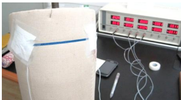
Рисунок 1.11 – Тестер контактного измерения давления воздушной подушкой AMI-3037 и система измерения давления (лаборатория Университета Дунхуа, Шанхай, Китай)
