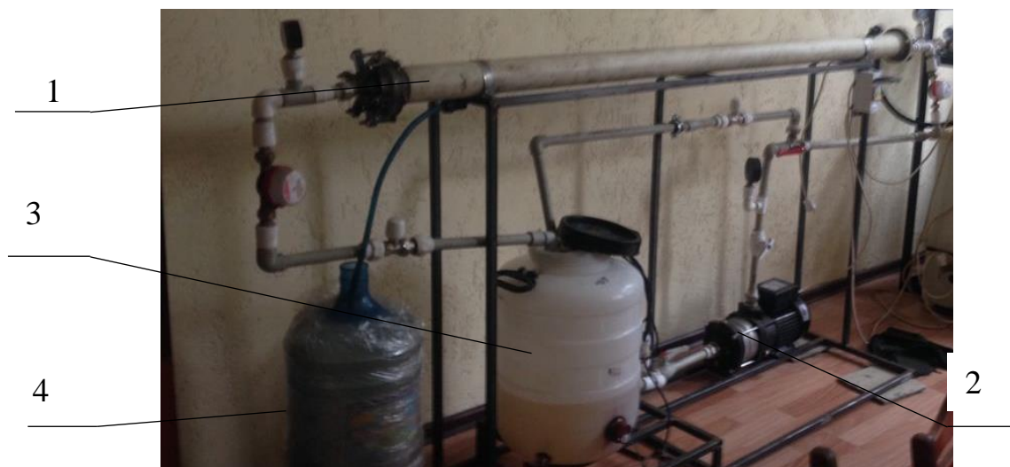
Рисунок 3.5 – Фотография лабораторной установки по разделению водомасляных эмульсий: 1 – ультрафильтрационный модуль БТУ-0,5; 2 - насос; 3 – бак с исходным раствором; 4 – бак с пермеатом
