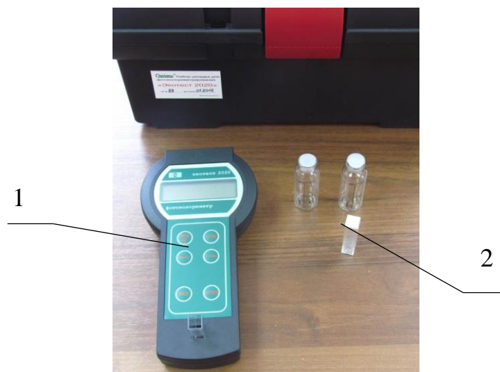
Рисунок 3.1 – Общий вид прибора "Экотест-2020-РС": 1 – фотоколориметр; 2 – фотометрическая кювета
