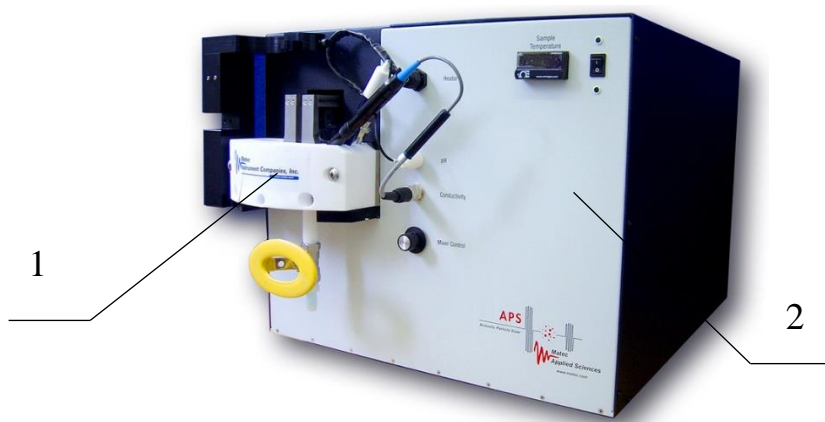
Рисунок 3.3 – Общий вид акустического анализатора частиц APS-100: 1 – измерительный блок; 2 – корпус с акустическим и электроакустическим зондами
