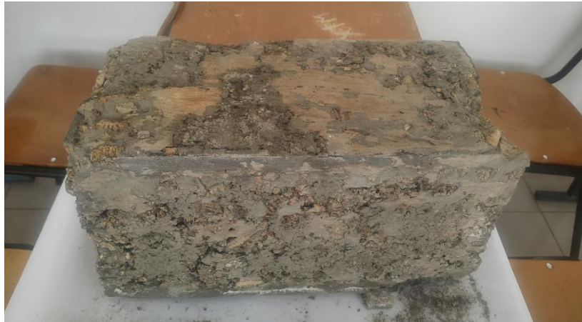
Рисунок 5.2. Шлакощелочной легкобетонный блок на основе кукурузных отходов
