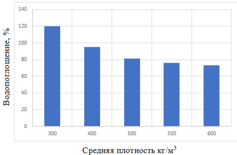
Рисунок 4.7. Зависимость водопоглощения от средней плотности шлакощелочного легкого бетона на основе кукурузных отходов
