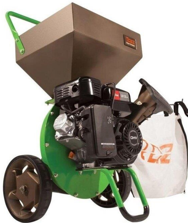
Рисунок 2.6 - Измельчительная машина марки Tazz K32
