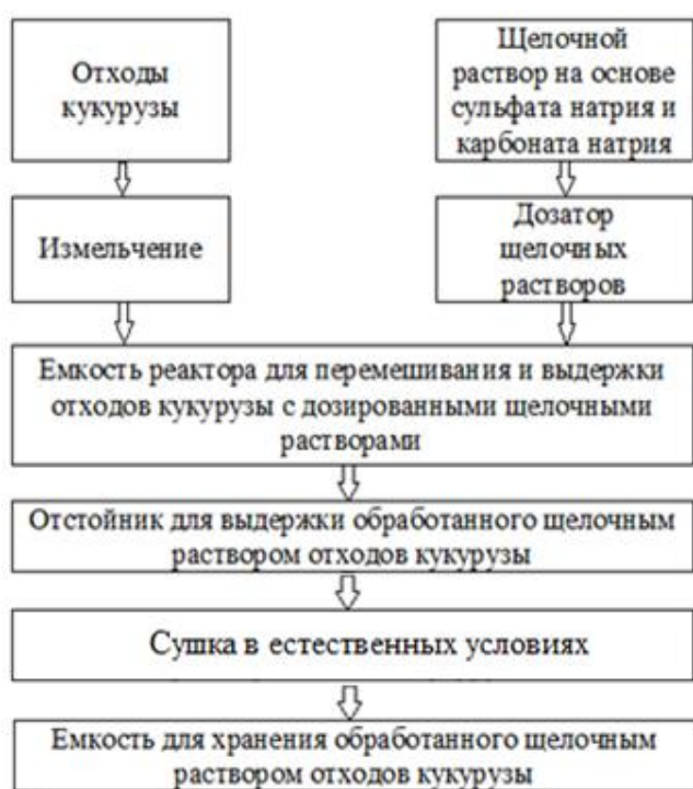
Рисунок 3 – Технология получения обработанных щелочным раствором кукурузных отходов
