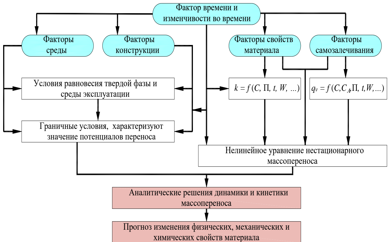
Рисунок 2.1. Схема методологии математического моделирования нестационарного массопереноса при коррозии бетона
