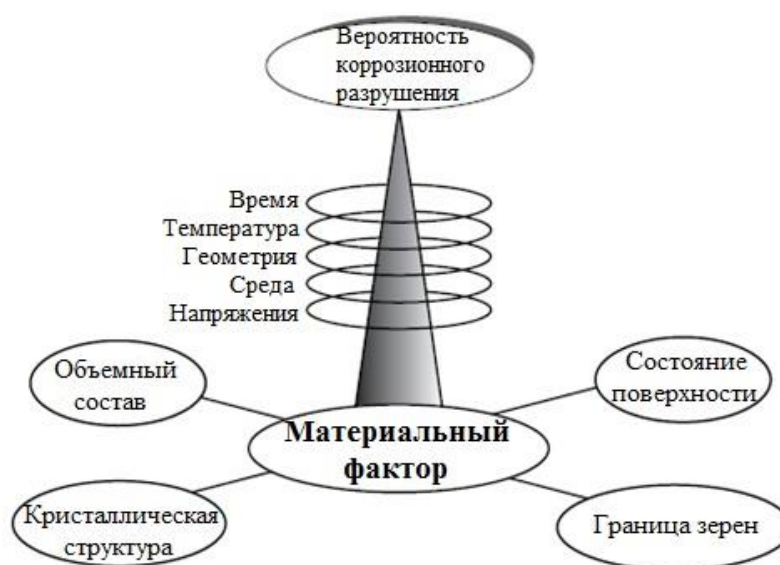
Рис. 1.12. Объектно-ориентированное представление материального фактора, управляющего вероятностью коррозионного разрушения
