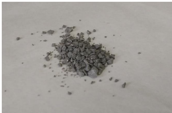
Рис. 2.10. Измельченный образец для проведения дифференциально-термического анализа цементного камня
