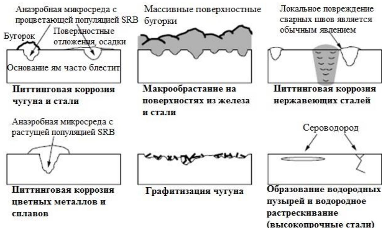
Рис. 1.8. Формы коррозионных повреждений металлов, вызванных сульфатредуцирующими бактериями
