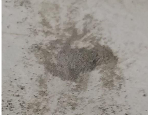
Рис. 2.7. Образец для проведения рентгенографического анализа фазового состава цементного камня
