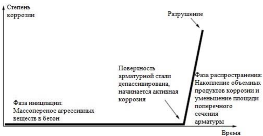
Рис. 1.9. Концептуальная модель коррозии арматуры в бетоне
