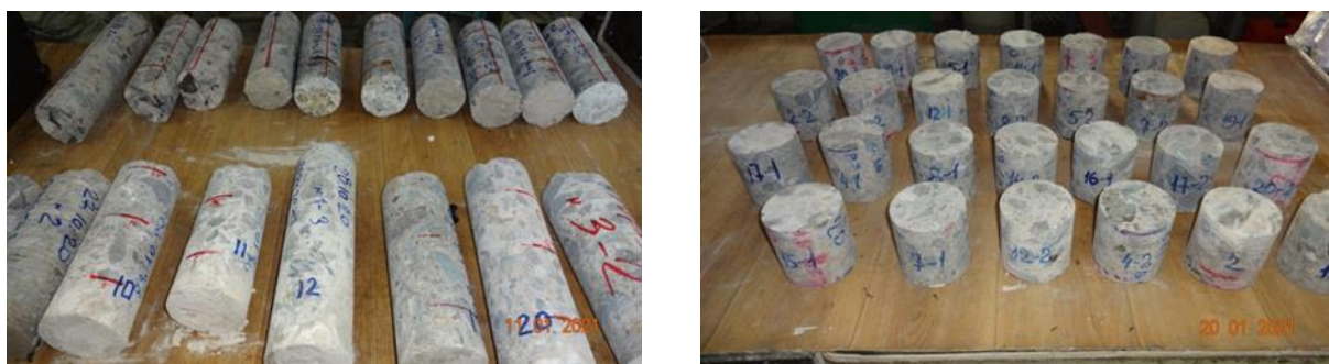
Рис. 2.9. Образцы проб бетона из сооружения: а) керны из конструкций диаметром 95 мм и длиной до 300 мм; б) образцы-цилиндры диаметром 95 мм и высотой 100 мм для определения механических и физических свойств бетона
