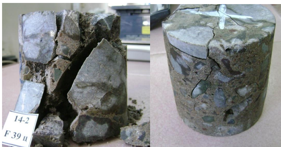
Рис. 3.17. Характер разрушения проб бетона из сооружения К1 после 39 циклов ПЗО при испытании по второму базовому методу ГОСТ 10060
