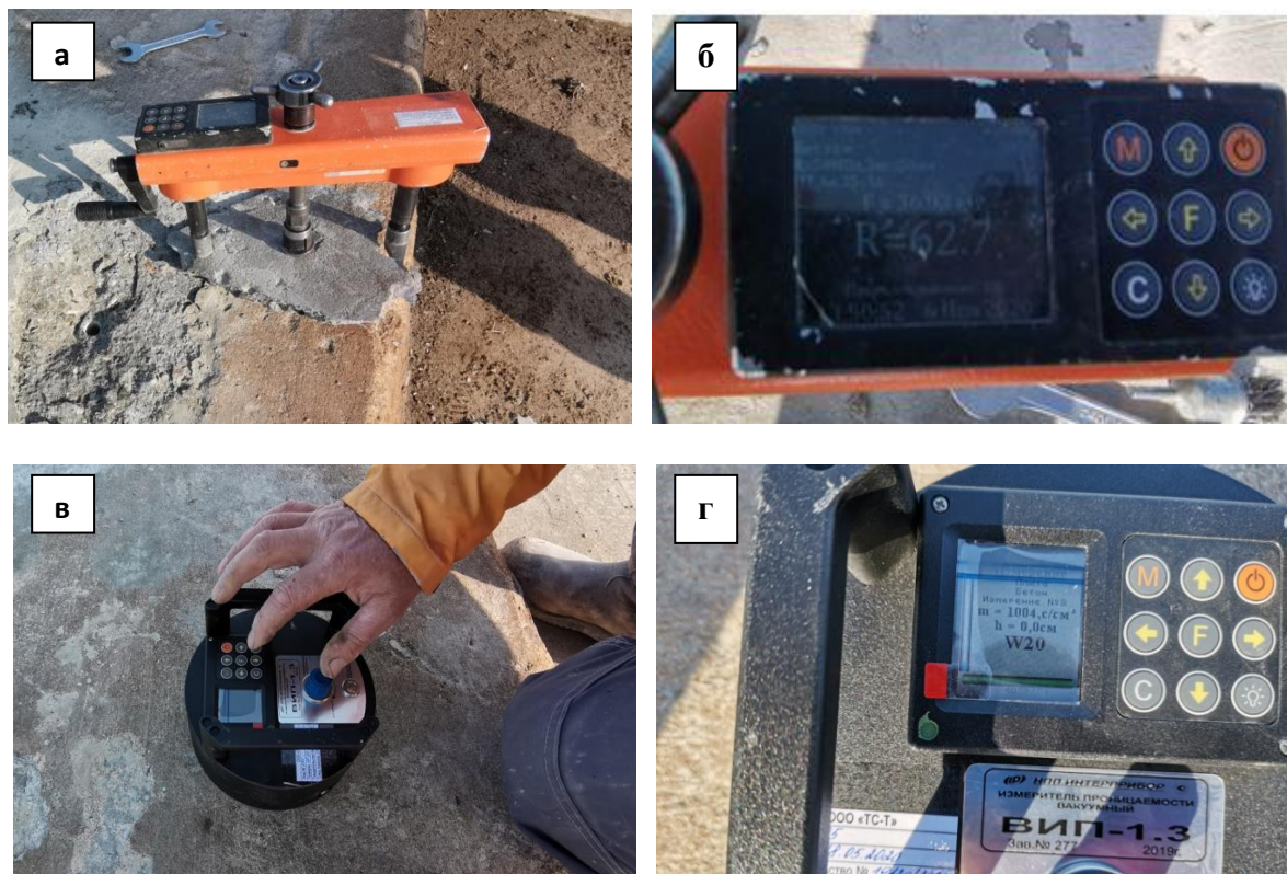
Рис. 2.10. а) и б) процесс определения прочности методом отрыва со скалыванием; в) и г) процесс определения водонепроницаемости по воздухопроницаемости бетона в конструкции прибором ВИП-1.3
