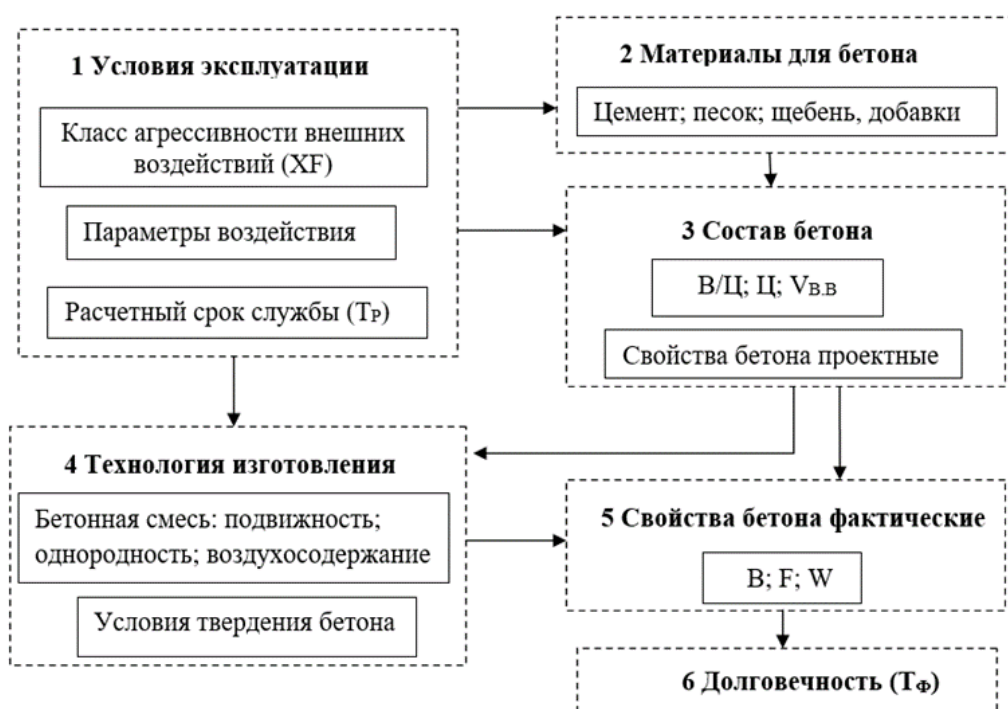
Рис. 2.8. Схема-алгоритм проектирования долговечности бетона для эксплуатации в морской воде в условиях замораживания-оттаивания [4, 5]
