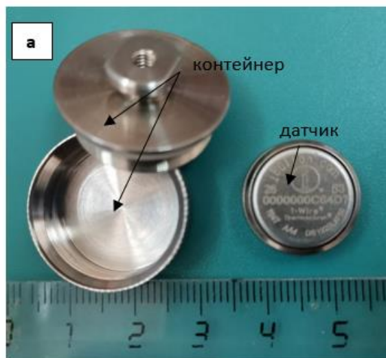
Рис. 3.3. Вид датчика для замера температуры бетона в зоне переменного уровня воды (а), подготовка к установке в конструкцию (тетрапод) датчика температуры (б)
