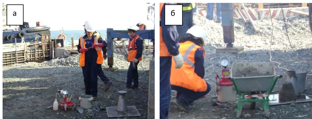
Рис. 2.12. Процесс подготовки (а) и испытание (б) бетонной смеси на воздухосодержание
