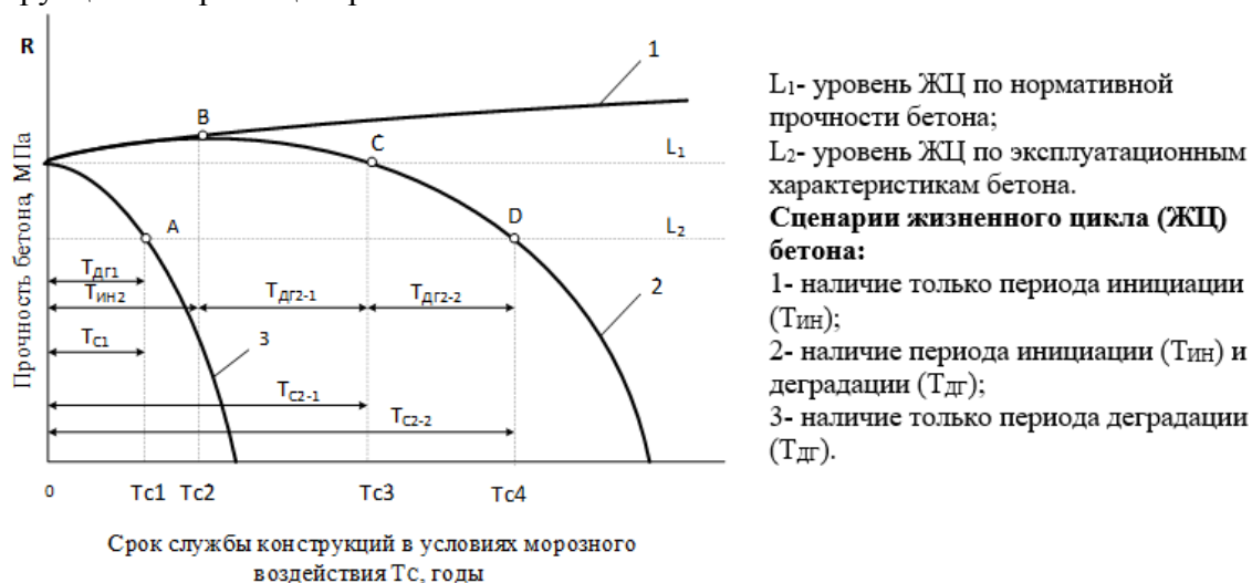
Рис. 7. Сценарии жизненного цикла бетона при морозном воздействии на основе натуральных исследований
