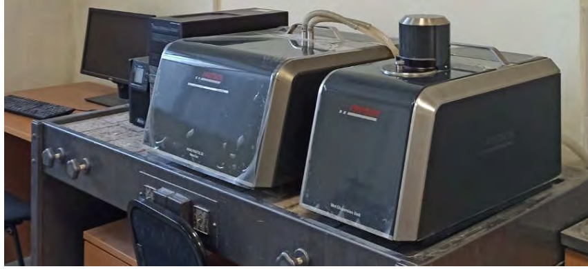
Рис. 2.1. Лазерный анализатор размера частиц
