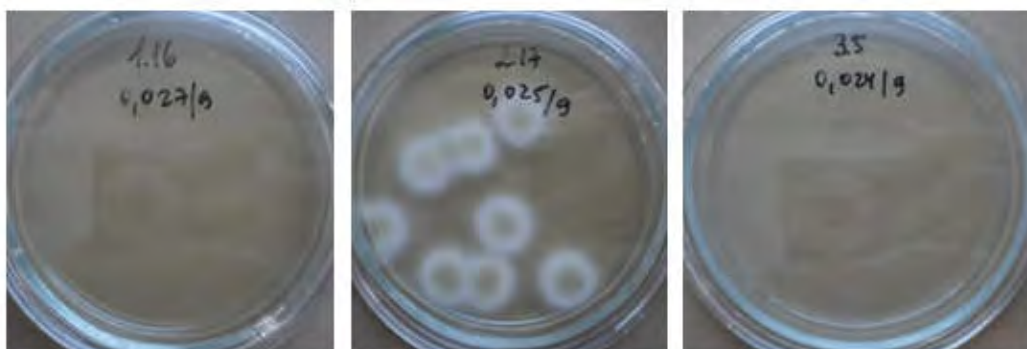
Рис. 2.12. Исследование соскобов штукатурных составов на наличие спор грибов
