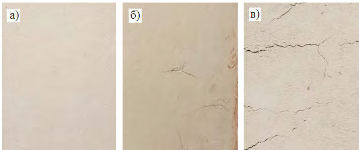
Рис. 3.21. Внешний вид штукатурного раствора с различным содержанием \text{Ca}(\text{OH})_2 : а) 9,3%; б) 11,7%; в) 12,1%
