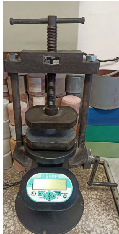
Рис. 2.5. Пресс для испытания образцов
