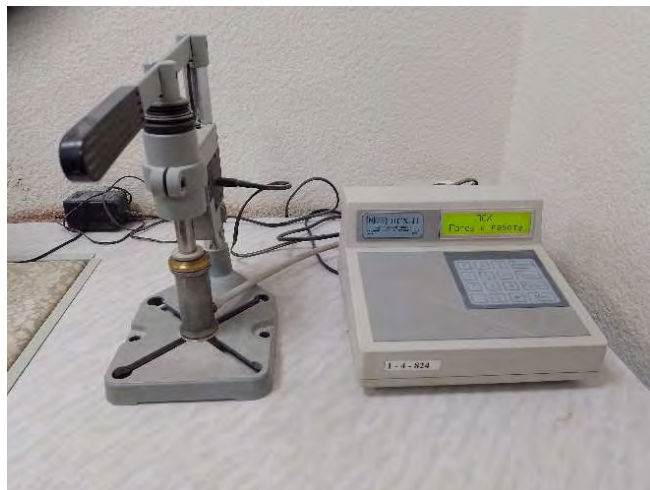
Рис. 2.2. Прибор для определения удельной поверхности ПСХ-11
