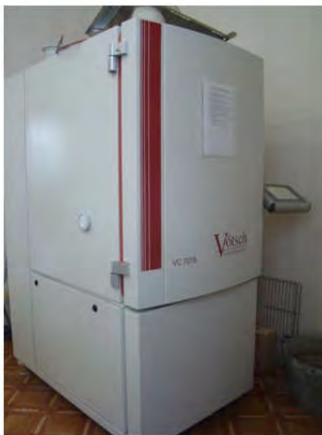
Рис. 2.9. Климатическая камера Vötsch VC 7018
