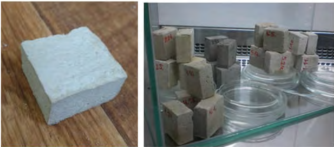
Рис. 2.10. Образцы штукатурных растворов для исследования грибостойкости
