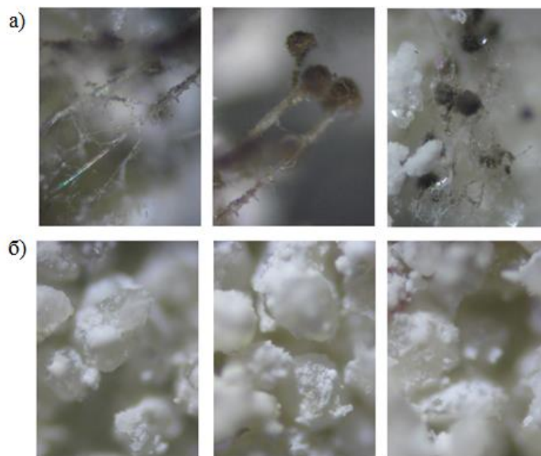
Рис. 5. Микрофотографии штукатурного раствора, после хранения в питательной среде в течение 84 суток, на основе: а) гипса; б) извести.
