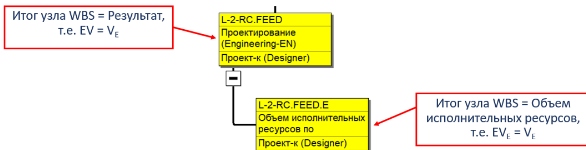
Рисунок 29. Схема применения Правила 2. Для формирования WBS с Ресурсно-контрактной декомпозицией без узла Физобъем
