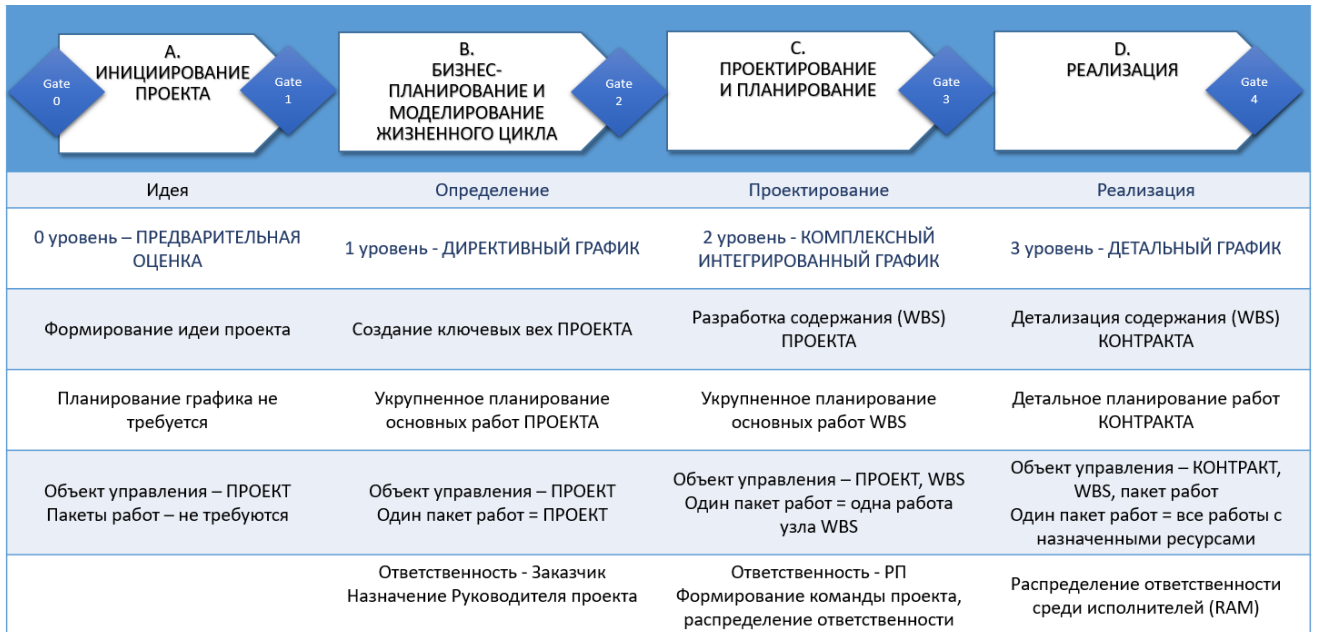
Рисунок 21. Соотношение уровней многоуровневой модели планирования и этапов жизненного цикла управления проектом строительства
