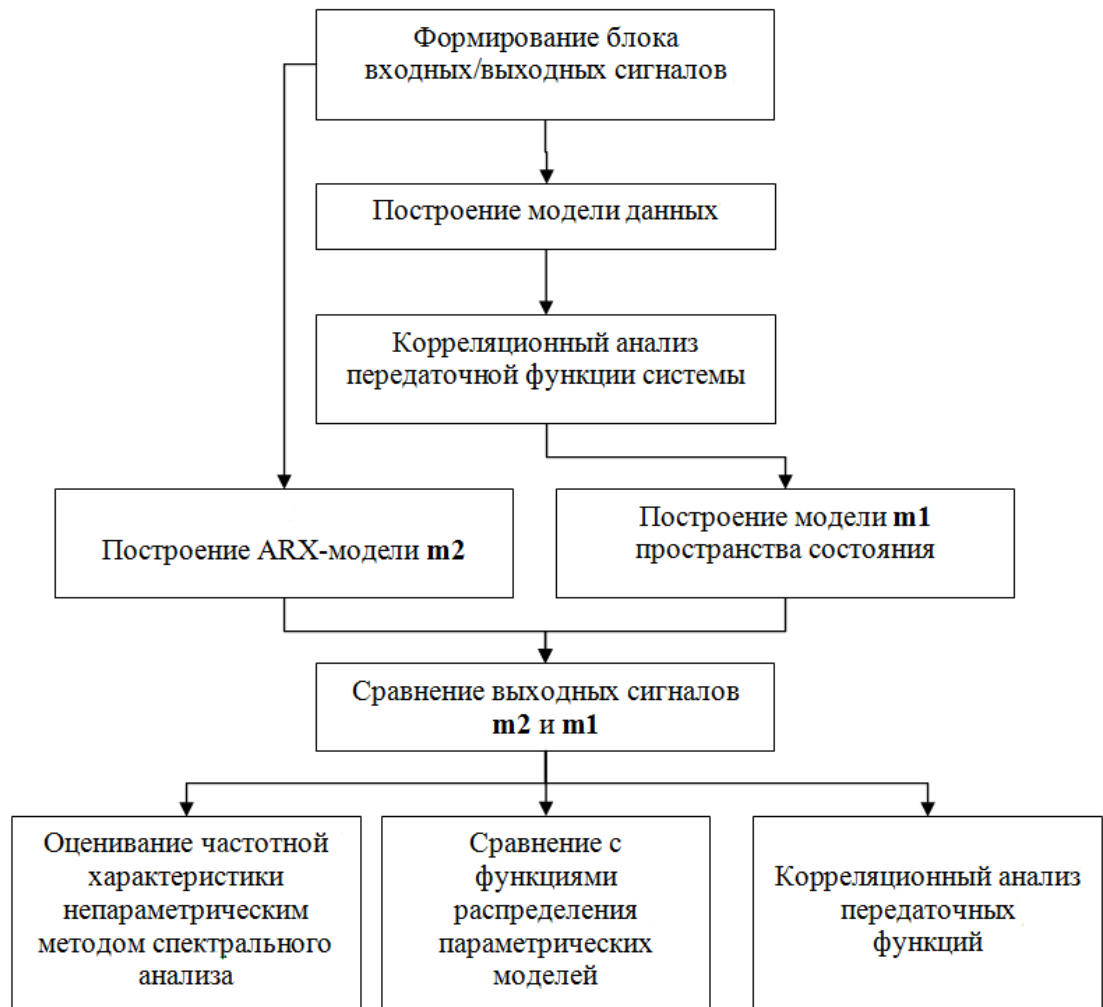
Рис. 44. Алгоритм идентификации модели переходных состояний процесса массопередачи при инфузионном процессе течения вязкой матрицы в волокнистой АС
