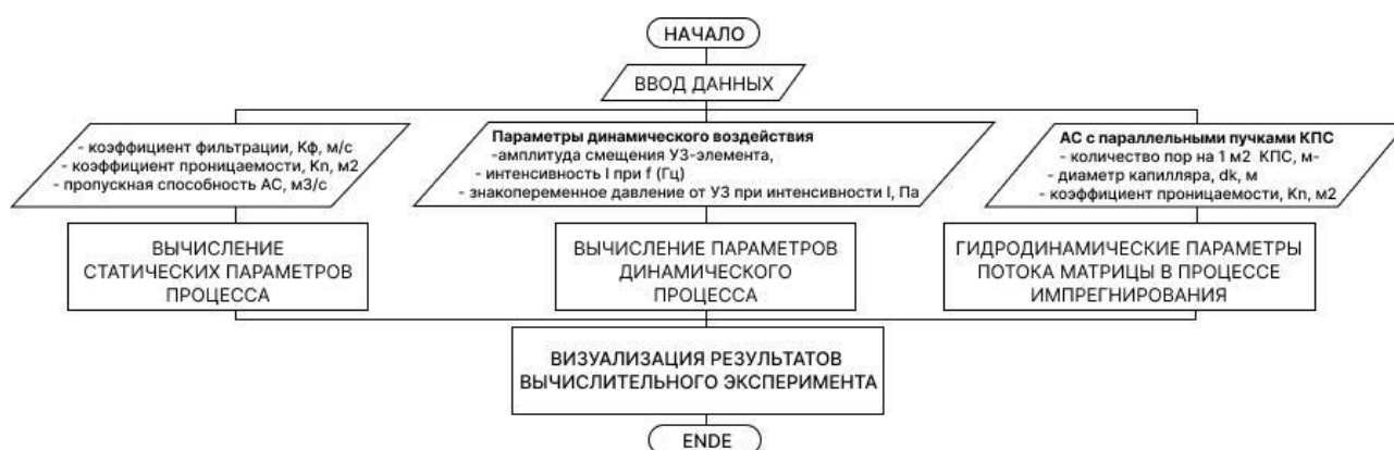
Рис. 8. Алгоритм численного анализа процесса синтеза капиллярно-пористой структуры волокнистого композитного материала
