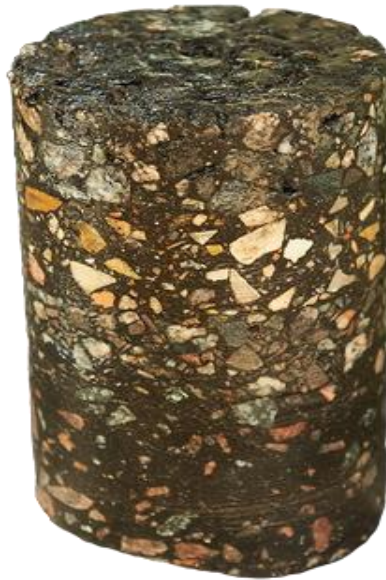
Рис. 3.2. Общий вид образца серии «Д» (с микрокремнеземом МК-85), через 300 суток погружения в раствор сульфата натрия в
