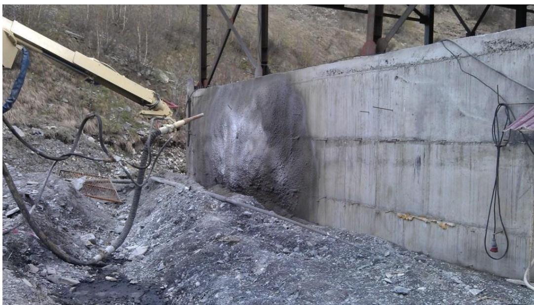
Рис. 1.3. Предварительные испытания ускорителя Центрамент Рапид 640 R перед применением в Рокском тоннеле
