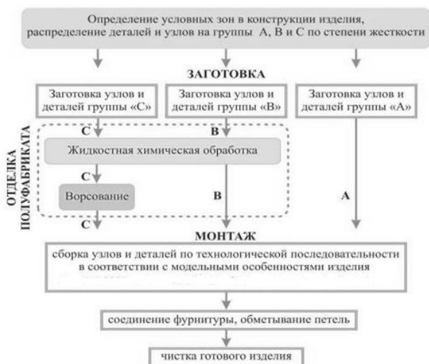
Рисунок 3 – Унифицированная схема изготовления изделий, совмещенная с процессами мягчения полуфабриката
