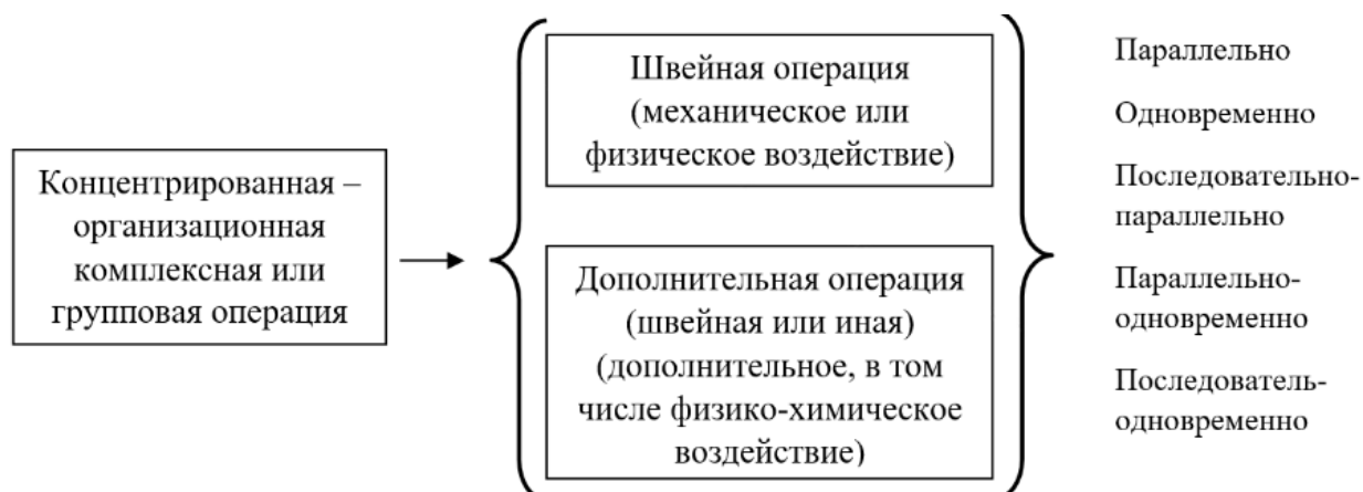
Рисунок 11 – Структура концентрированной операции с элементами физико-химического воздействия
