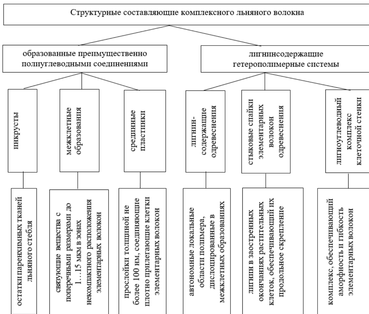
Рисунок 4 – Структурные составляющие комплексного льняного волокна
