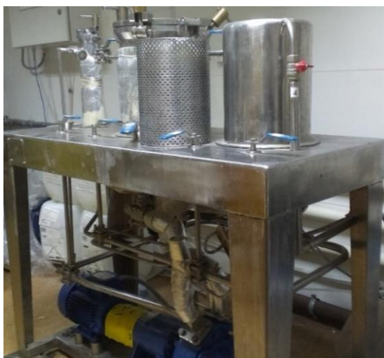
Рисунок 17 – Внешний вид лабораторной установки для реализации жидкостного способа биообработки льняных материалов
