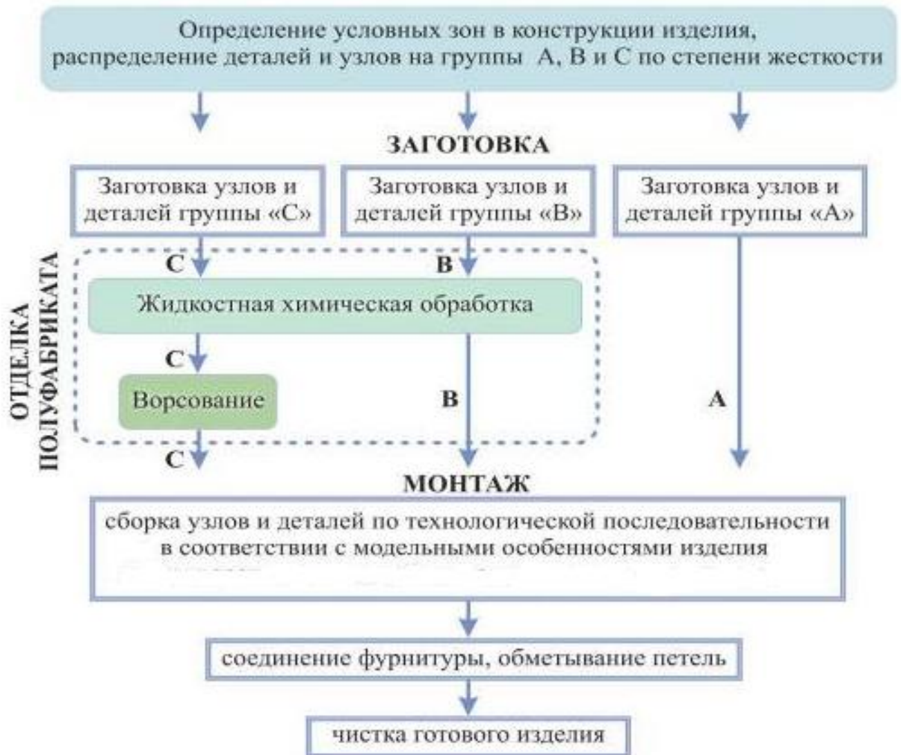
Рисунок 42 – Унифицированная схема изготовления изделий с использованием жидкостной технологии мягчения полуфабриката
